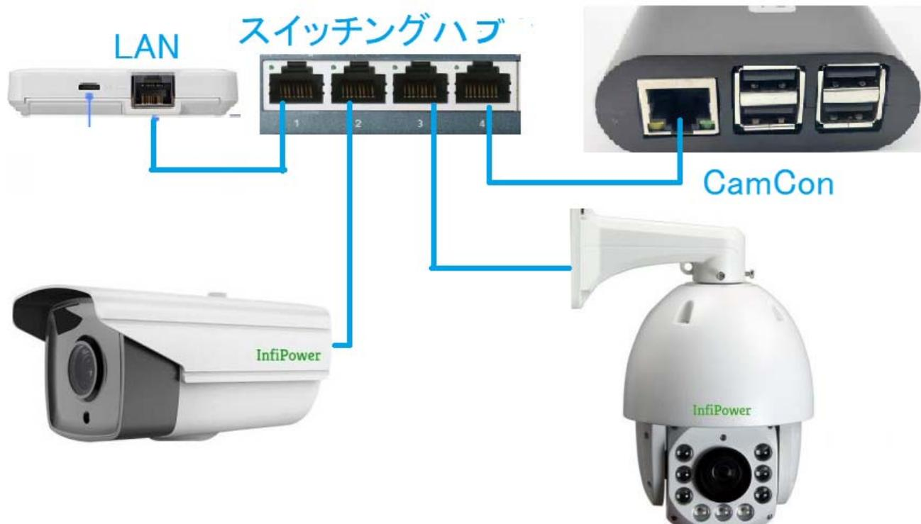
3. CamCon、ハブ、ルータを適切な場所にネジか強力両面テープで固定します
