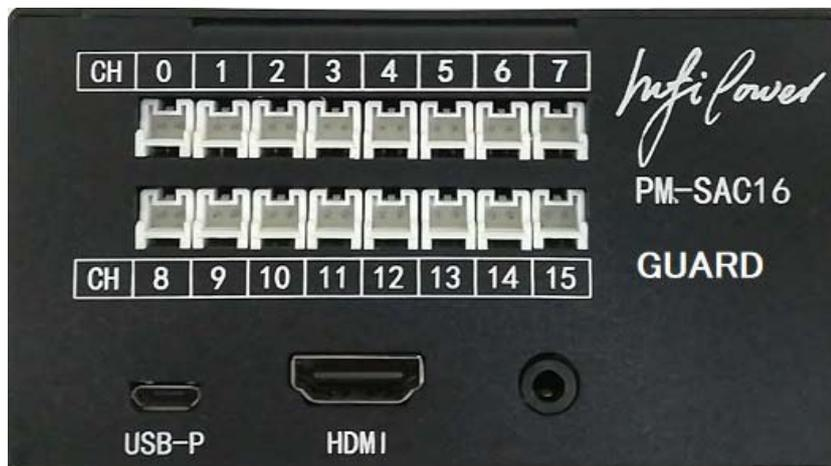
本体正面の CH0～7 はモジュール 0 として、各チャンネル 0～7 はポート 0～7 に対応しています。CH8～15 はモジュール 1 として、チャンネル 8～15 はモジュール 1 のポート 0～7 に対応しています。各ポートに CT センサーが繋がって監視の必要があれば、そのポートの緑のボタンを On までクリックし、観測の必要がなければ、OFF までクリックして、最後保存ボタンをクリックして設定を保存してください。
